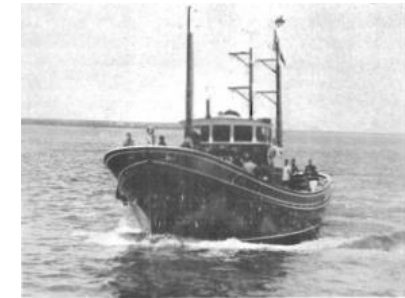
FIG. 15. — « Robert Michel III », l'un des récents thoniers à coque espagnole (remarquer les potences soutenant les deux maroquins latéraux) (phot. J. Velez, St-Jean-de-Luz).
